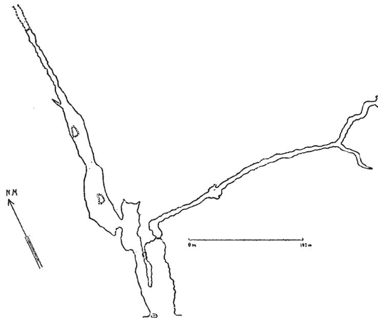
Fig. 9.—Plano esquemático de Cueva Grande. Portal de hundimiento en la entrada; galería E., según una diaclasa del sistema E-W, etapa de madurez; galería N, según una diaclasa el sistema N-S. con dos claraboyas, etapa de senectud.
